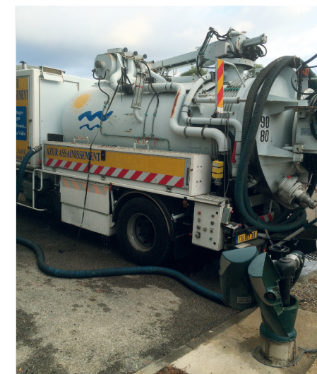
Usage autorisé mais non réglementé : camion hydrocureur s'alimentant en eau traitée sur borne de puisage (de l'ordre de 500 m 3 d'eau réutilisée par an) qualité A
