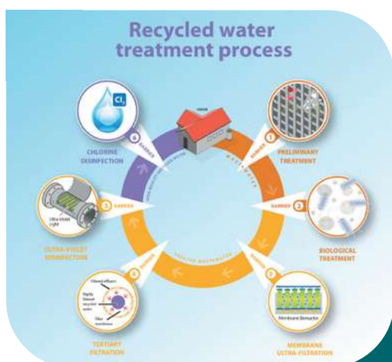
Figure 5. Processus de traitement des eaux usées de Googong. Source : Conseil régional de Queanbeyan-Palerang (n.d.) .
