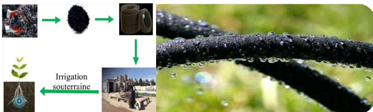
Figure 6. Schéma du système d'irrigation souterraine (à gauche) et image détaillée des Mipotubes INNARI.
