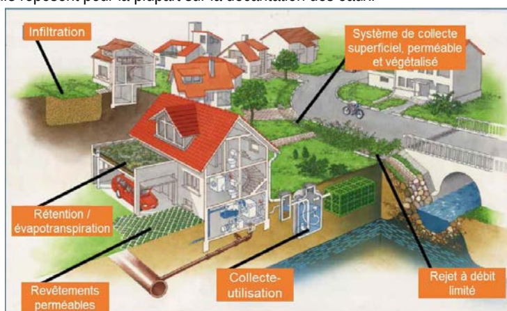
Figure 3-3. Gestion à la source des eaux pluviales (adaptée de Bayerisches Landesamt für Umwelt)
